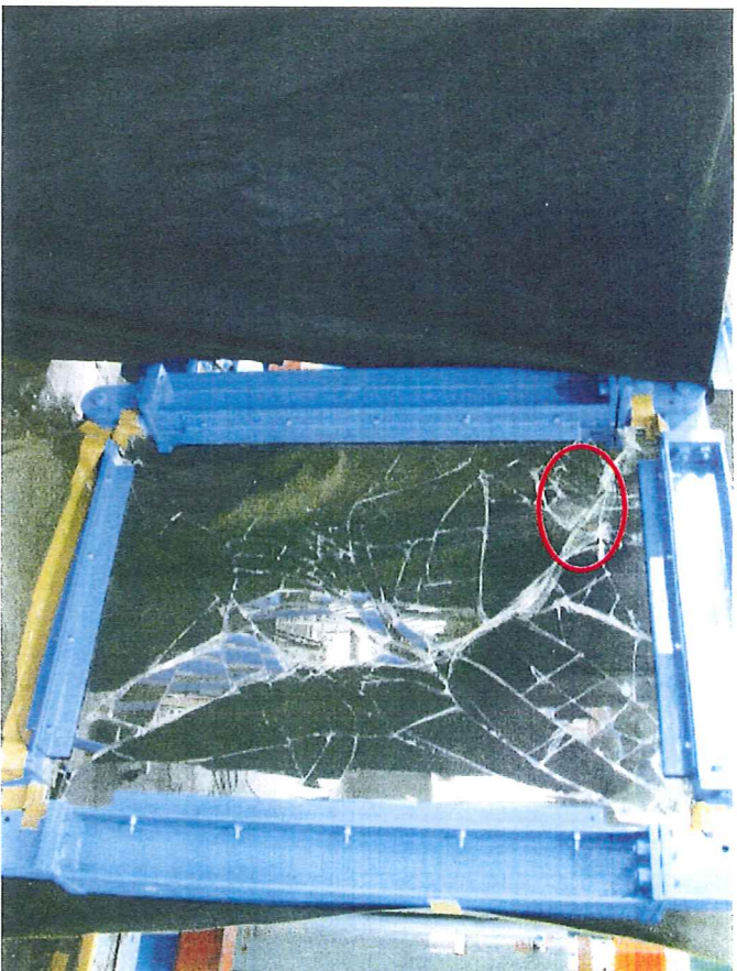
写真 10 破壊状況 試験項目：層間変位 試験片番号：B-1 ・板ガラスの破壊及びフレームの切れ (○ 部分でフレームの切れ)
