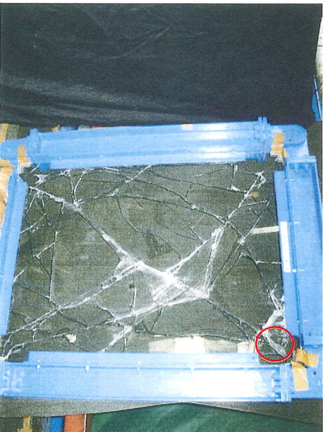
写真-12 破壊状況 試験項目：層間変位 試験片番号：B-4 ・板ガラスの破壊及びフィルムの切れ (○ 部分でフィルムの切れ)
