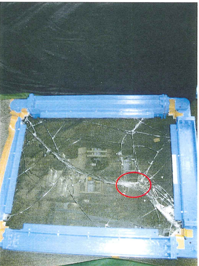
写真 10 破壊状況 試験項目：層間変位 試験片番号：B-2 ・板ガラスの破壊及びフレームの切れ (○ 部分でフレームの切れ)
